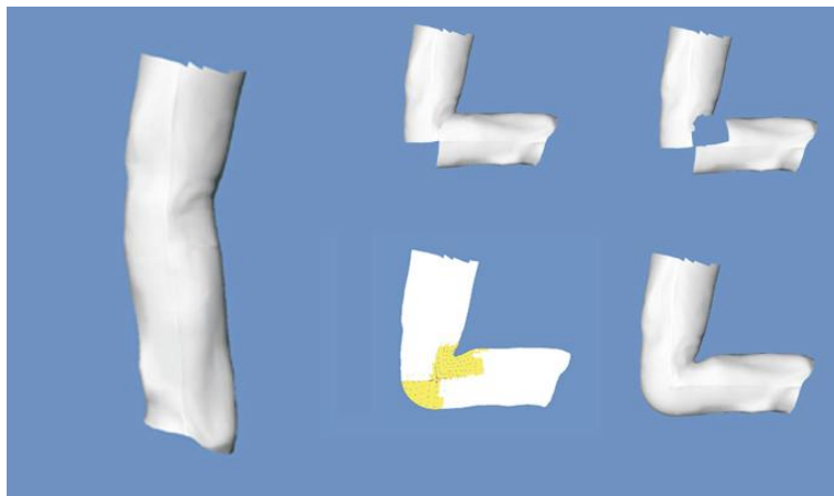
Rysunek 5.7.38. Z lewej: model ręki. Lewy górny róg: zgięta ręka, widać lukę w geometrii. Prawy górny róg: usunięte punkty. Lewy dolny róg: wypełnienie szczelin. Prawy dolny róg: poprawnie zgięta (animowana) ręka. Obrazek pobrany z [88].
